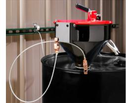
**LOS CABLES DE CONEXIÓN A TIERRA DEBEN ESTAR INSTALADOS:**
